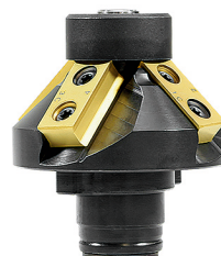
Abb. 45°-Fasen-Fräser mit 4 Schneiden und Führungsrolle, bestückt mit 4 Fasen-Wendeschneidplatten vom Typ D
